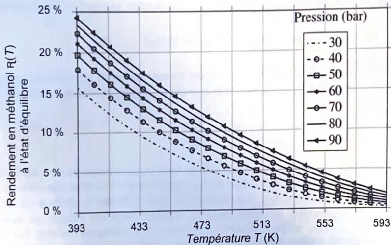
Figure 3 - Courbes représentatives du rendement en méthanol  $R(T)$ , à l'état d'équilibre, pour différentes pressions  $P$
