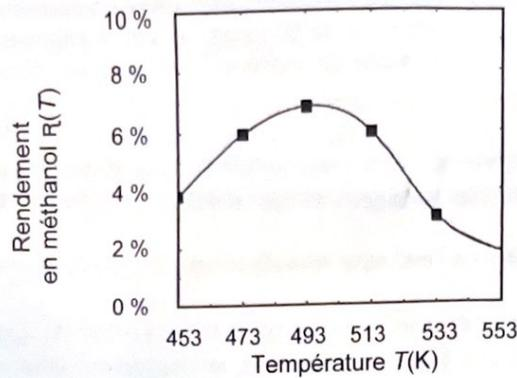
**Figure 4** - Rendement en méthanol  $R(T)$ , en fonction de la température  $T$ , mesuré au bout de 1 h de durée de la réaction (1)
