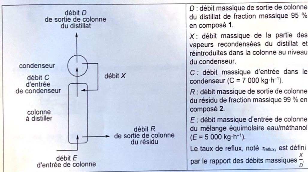
Figure 6 - Schéma simplifié du procédé de rectification continue
