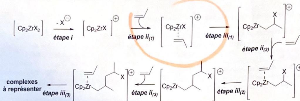
**Figure 2** - Mécanisme simplifié de la polymérisation par coordination du propylène
