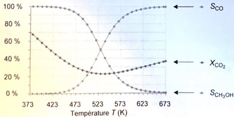
**Figure 5** - Influence, à l'état d'équilibre, de la température  $T$  sur le taux conversion du dioxyde de carbone  $X_{\text{CO}_2}$  et les sélectivités  $S$  en méthanol  $S_{\text{CH}_3\text{OH}}$  et en monoxyde de carbone  $S_{\text{CO}}$ , pour les réactions impliquées dans l'hydrogénation de  $\text{CO}_2$ .
